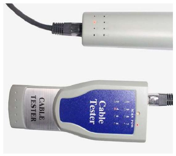
发射器拨至"关/测线"档位,接收器处于关机状态,连接线缆,发射器和接收器的线序指示灯会依次亮起,根据发射器与接收器上的8个状态指示灯闪亮情况判定线路状况。
